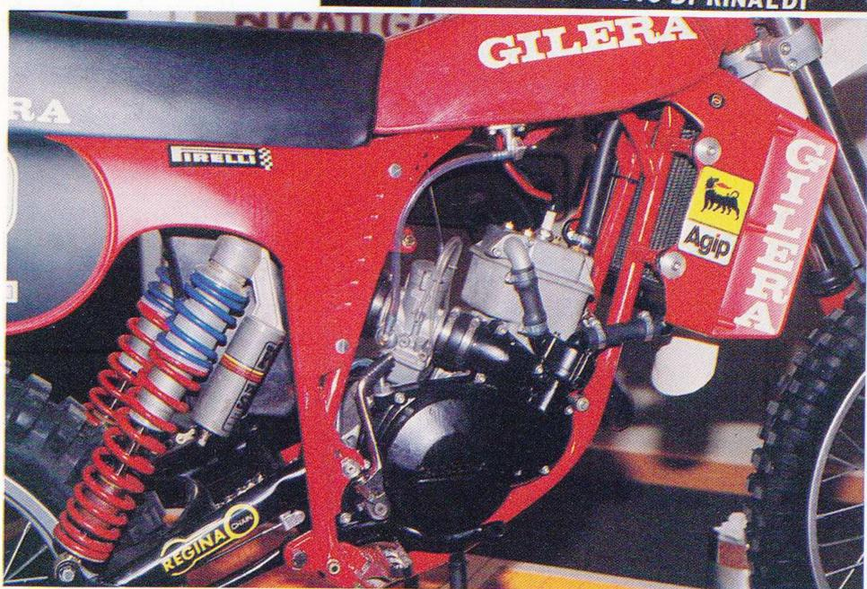
della 125 affidata a Nani, Perfini e Rahier, ma è spinta da un inedito bicilindrico, anch'esso con ammissione a disco rotante, nel quale i cilindri inclinati in avanti sono sovrapposti e i cui alberi motore sono perfettamente allineati sullo stesso asse. Forse in Gilera mettono troppa carne al fuoco, tenendo presente che sono impegnati contemporaneamente anche in 250, disperdendo le risorse del Reparto corse e i risultati a livello iridato sono inferiori alle aspettative.
