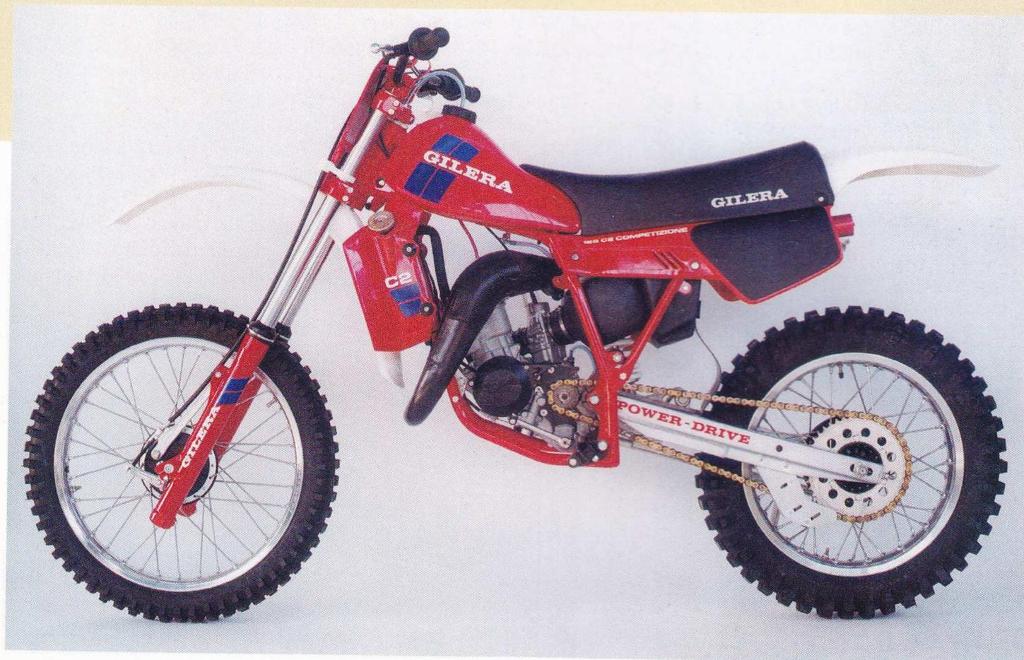
stesse misure di alesaggio per corsa del precedente (56x50 mm) ma ha i carter in magnesio di disegno simile a quelli della 250 e una nuova testa.
