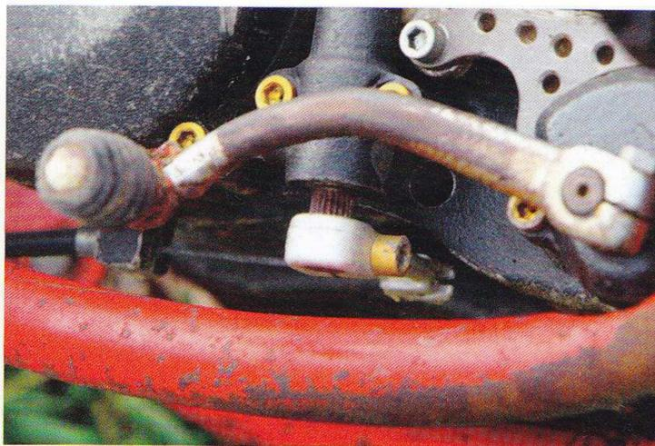
• A sinistra, il silenziatore di scarico era realizzato dalla Motomeccanica Silenziatori Alluminio. Qui a fianco, la levetta della frizione collocata nella parte inferiore del basamento sotto al pignone e in prossimità della leva del cambio.
