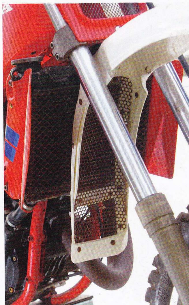
• A fianco, il particolare dell'ampia finestra con griglia antisassate di protezione, ricavata nel parafango anteriore per far respirare il radiatore dell'acqua. Quest'ultimo veniva realizzato in Giappone seguendo specifiche Gilera.
