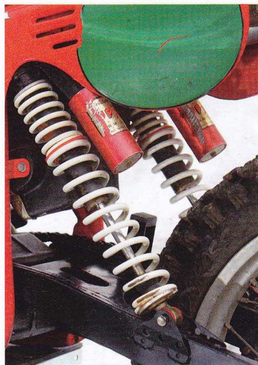
• Sopra, la coppia di ammortizzatori posteriori regolabili WP a gas e il forcellone scatolato in acciaio saldato a TIG. Qui a sinistra, vediamo il particolare della traversa scatolata di irrigidimento dotata di due sfinestrature asimmetriche che unisce i due bracci del forcellone.
