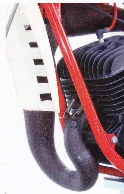
• L'espansione è dotata di una sottile griglia paracalore - per proteggere la gamba destra del pilota da contatti e scottature - saldata direttamente su di essa. Inoltre, come si può notare nella foto qui sopra e nel particolare a sinistra, l'espansione è fissata al telaio con l'interposizione di silent-bloc antivibratori in gomma. Sopra, le finestrature ricavate nel parafango anteriore per far arrivare più aria a testa e cilindro.
