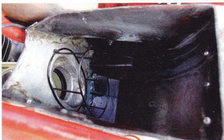
• A destra, il carburatore Dell'Orto PHSB da 36 mm con corpo in magnesio. Realizzato per le gare di Velocità, è stato adottato dalla Gilera con opportune modifiche per meglio "accordarlo" all'ammissione a disco rotante, sulla 250 ad aria, ma anche sulle 125 ad acqua dello stesso periodo. A sinistra, la scatola filtro, realizzata in lega leggera e plastica.
