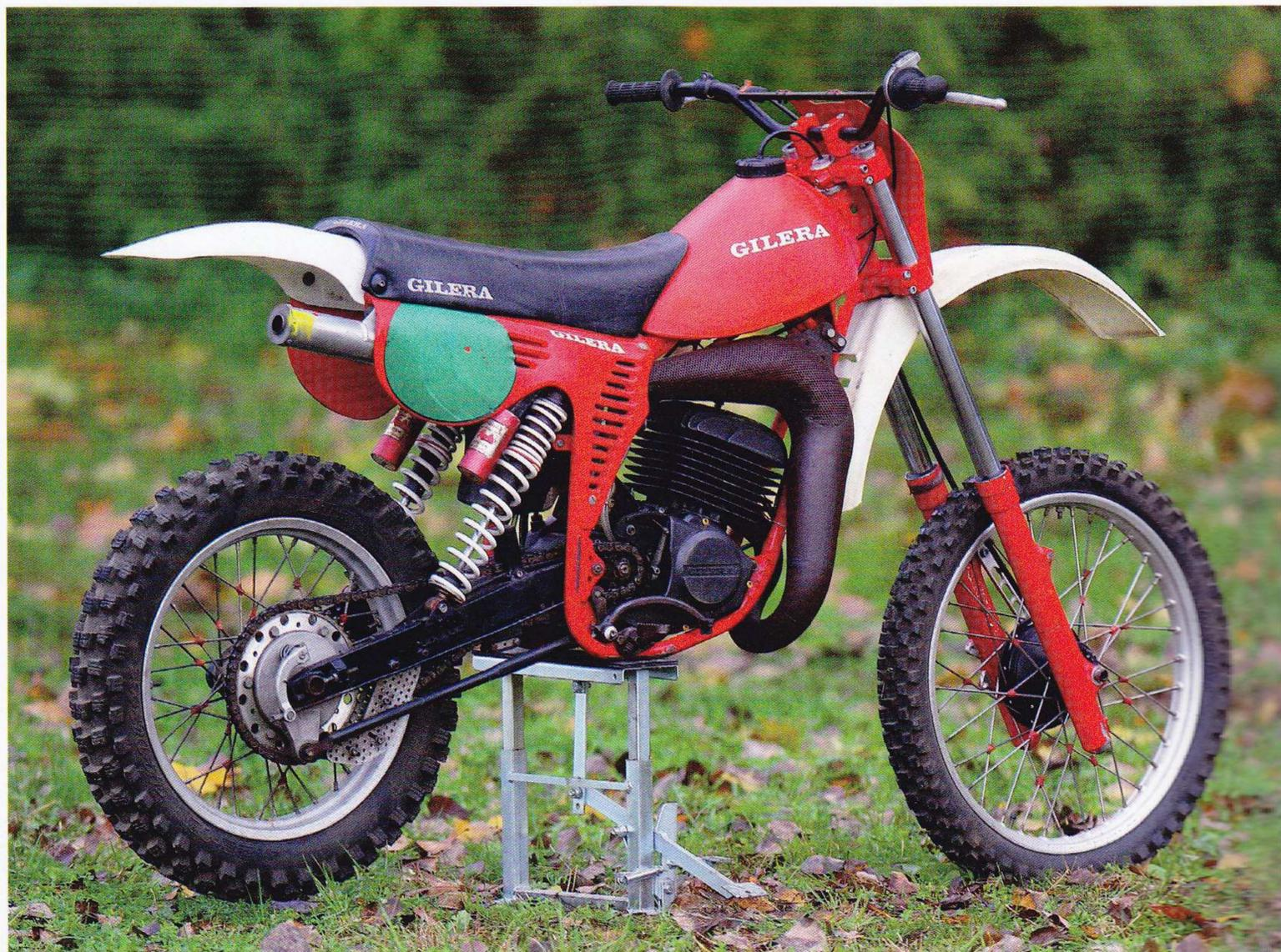
• La Gilera 250 Cross con motore raffreddato ad aria ha corso per quattro stagioni ed è stata costruita in meno di dieci esemplari nel Reparto corse di Arcore. Sotto, nelle viste fronte e retro viene evidenziato il ridotto ingombro della moto e l'andamento dell'impianto di scarico, la cui curva occupa la parte frontale destra della moto. Notare la notevole lunghezza delle sospensioni.
