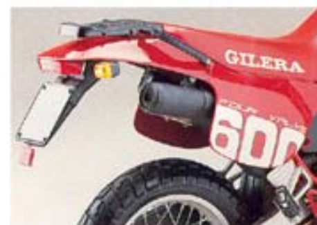
Vista parte posteriore veicolo con faretto di nuovo disegno e indicatori di direzione
