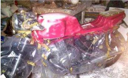
Tutta la scocca in gesso è isolata con smalto e Una volta delimitati i numeri di pezzi si cera. procede con il creare dei tasselli che impediscano il sottosquadro e che si possano sfilare senza problemi. Vengono create pareti in argilla che corrono lungo i crinali di sezione dei vari pezzi. Le pareti possono essere realizzate con svariati materiali a seconda delle necessità, con cartone, plastilina, lamelle di ferro ecc..
