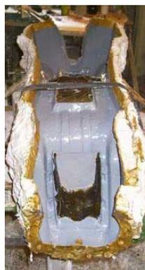
asciugato (la carta del quotidiano va benissimo) per poter essere riutilizzato. Si preparano dei pezzi di fibra di vetro, si catalizza la resina poliestere e s'impregna all'interno del calco, sullo strato di gelcoat. L'
