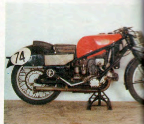
1937 La 500 con compressore senza carenatura mette in evidenza tutte le particolarità meccaniche fra cui il raffreddamento a liquido
