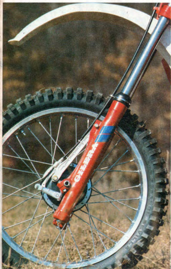
La forcella, sopra, personalizzata con il marchio Gilera, è una Marzocchi «Piffero» a perno avanzato da 38 mm Ø. Sotto, il mozzo posteriore Grimeca da 125 mm Ø con piatto portaceppi flottante
