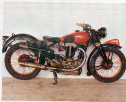
1937 La 500 «4 Bulloni» era una monocilindrica a quattro tempi con distribuzione ad aste e bilancieri con valvole in testa
