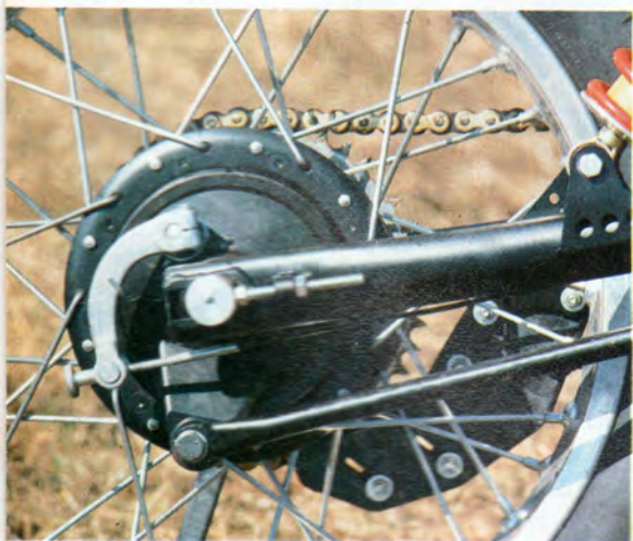
La forcella, sopra, personalizzata con il marchio Gilera, è una Marzocchi «Piffero» a perno avanzato da 38 mm Ø. Sotto, il mozzo posteriore Grimeca da 125 mm Ø con piatto portaceppi flottante
