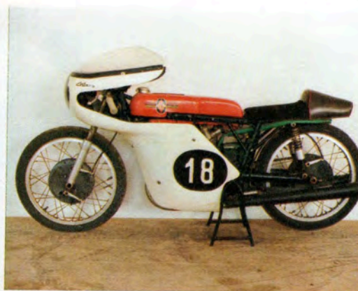
1956 Snella e filante come un ermellino era la 125 GP bicilindrica bialbero con la notevole potenza di 20 Cv a 12000 giri
