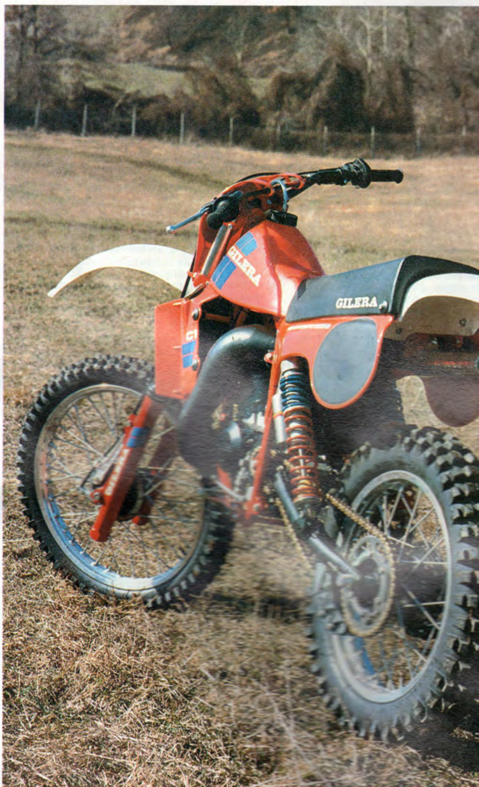
La forcella, sopra, personalizzata con il marchio Gilera, è una Marzocchi «Piffero» a perno avanzato da 38 mm Ø. Sotto, il mozzo posteriore Grimeca da 125 mm Ø con piatto portaceppi flottante
