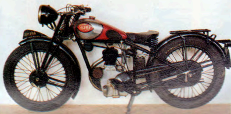
Due modelli del 1936: sopra la 500 L 2ª serie, sotto la 220 tipo Nord denominata «Sirio». Pur cambiando la cilindrata risulta evidente la similitudine fra dimensioni del cilindro e quelle del carter motore, in proporzione esattamente opposte a quanto si vede sulle moto moderne. Gli accenti non facevano (apparentemente) parte delle preoccupazioni dei disegnatori: lo dimostra il faro anteriore sostenuto da «bacchette» e la borsetta in cuoio con relativa serratura. Anche la sospensione posteriore, si rimanda con robuste molle sotto il sellino, è di tipo ciclistico
