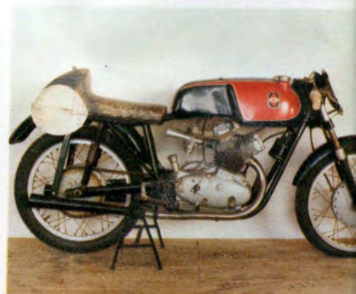
1957 Dalla 125 bicilindrica venne derivata la 175, praticamente immutata architettonicamente, ma con 22 Cv a 11000 giri
