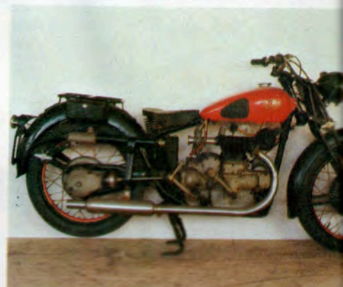
1942 La 500 VL Marte si distingueva per trasmissione finale ad albero cardanico e per la possibilità di montare un side-car
