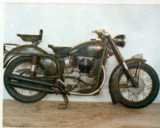
1952-58 La Saturno 500 fu proposta anche in versione militare, irrobustita in svariati elementi e con sospensioni telescopiche
