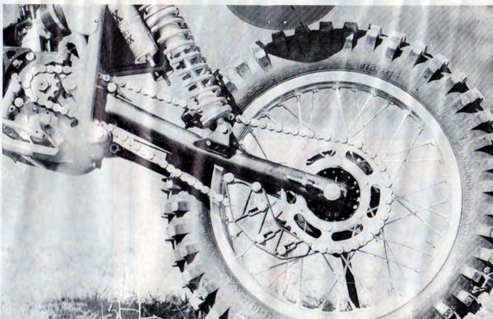
La Gilera, ha preferito rinunciare al monoammortizzatore per il più collaudato sistema tradizionale. Il forcellone lavora infatti in collaborazione con una coppia di ammortizzatori Corte e Cosso o FOX. Sotto, ancora Fulgoni in prova
