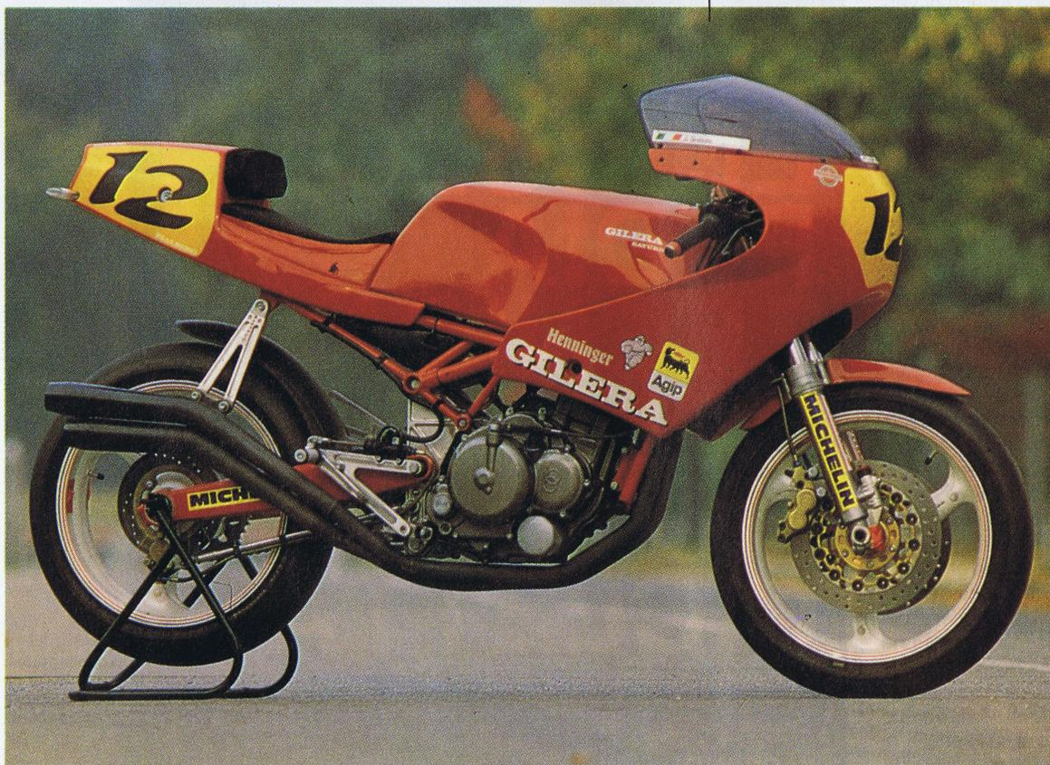
Il cilindro è della RC 600 e la testata è della Saturno. Alesaggio e corsa sono ora 98x74 (invece di 92x74), la cilindrata è 560 cc. Maggiorate le valvole: 36 aspirazione e 31 scarico (serie: 31 e 28 mm). I condotti sono lucidati, allargati al seggio e raccordati a zero sull'imboccatura. Il carburatore da 42 ha il getto del massimo da 170 e non c'è cassetta filtro. Completamente libero anche lo scarico, sdoppiato sin dai collettori sulla testata. La potenza è salita a 55 cavalli.
