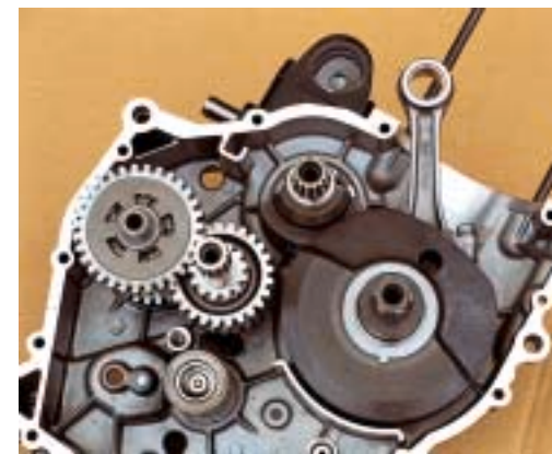
Una vista del carter aperto che mostra gli ingranaggi del cambio ed in alto l'albero equilibratore.
