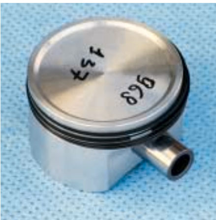
Il cilindro con canna integrale, dotata di riporto superficiale al nichel-carburo di silicio, e il pistone stampato, privo dei consueti incassi per le valvole.
