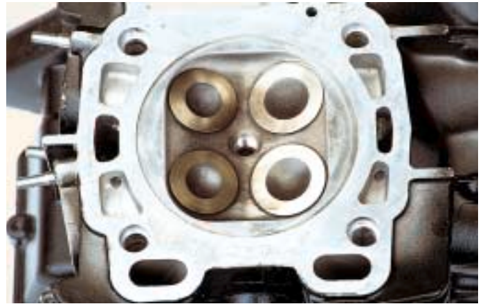
Due viste della testata. I due alberi a camme sono comandati da cinghia dentata. Per il Piuma la Casa consiglia di cambiare la cinghia al massimo ogni dieci ore di funzionamento.
