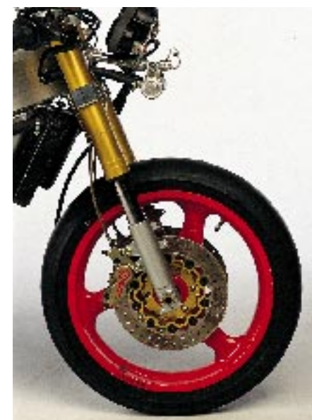
In alto, la Saturno stradale è frenata da un solo disco di grosso diametro. La Piuma invece, ne ha due di diametro inferiore. Al centro, differenti tra i due modelli anche le forcelle. In basso, il freno posteriore della moto da strada è più grande di quello della moto da corsa che ha anche una pinza più piccola. Per la registrazione della catena, sulla moto stradale c'era un eccentrico nel forcellone mentre la Piuma aveva la classica asola.
