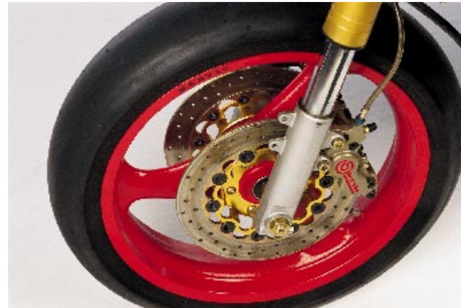
In alto, la Saturno stradale è frenata da un solo disco di grosso diametro. La Piuma invece, ne ha due di diametro inferiore. Al centro, differenti tra i due modelli anche le forcelle. In basso, il freno posteriore della moto da strada è più grande di quello della moto da corsa che ha anche una pinza più piccola. Per la registrazione della catena, sulla moto stradale c'era un eccentrico nel forcellone mentre la Piuma aveva la classica asola.
