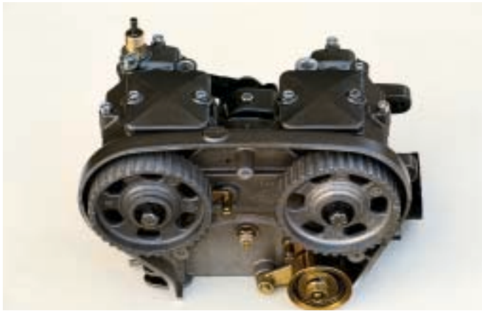
Due viste della testata. I due alberi a camme sono comandati da cinghia dentata. Per il Piuma la Casa consiglia di cambiare la cinghia al massimo ogni dieci ore di funzionamento.
