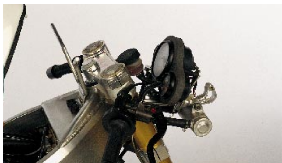
La strumentazione del modello stradale oltre al contagiri e al termometro dell'acqua ha logicamente anche il contachilometri che manca invece sul modello da corsa.
