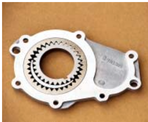
La pompa dell'olio ad ingranaggi interni. I Gilera bialbero sono gli unici motori motociclistici al mondo a montare questo tipo di pompa.
