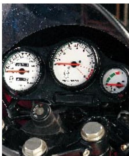
La strumentazione del modello stradale oltre al contagiri e al termometro dell'acqua ha logicamente anche il contachilometri che manca invece sul modello da corsa.
