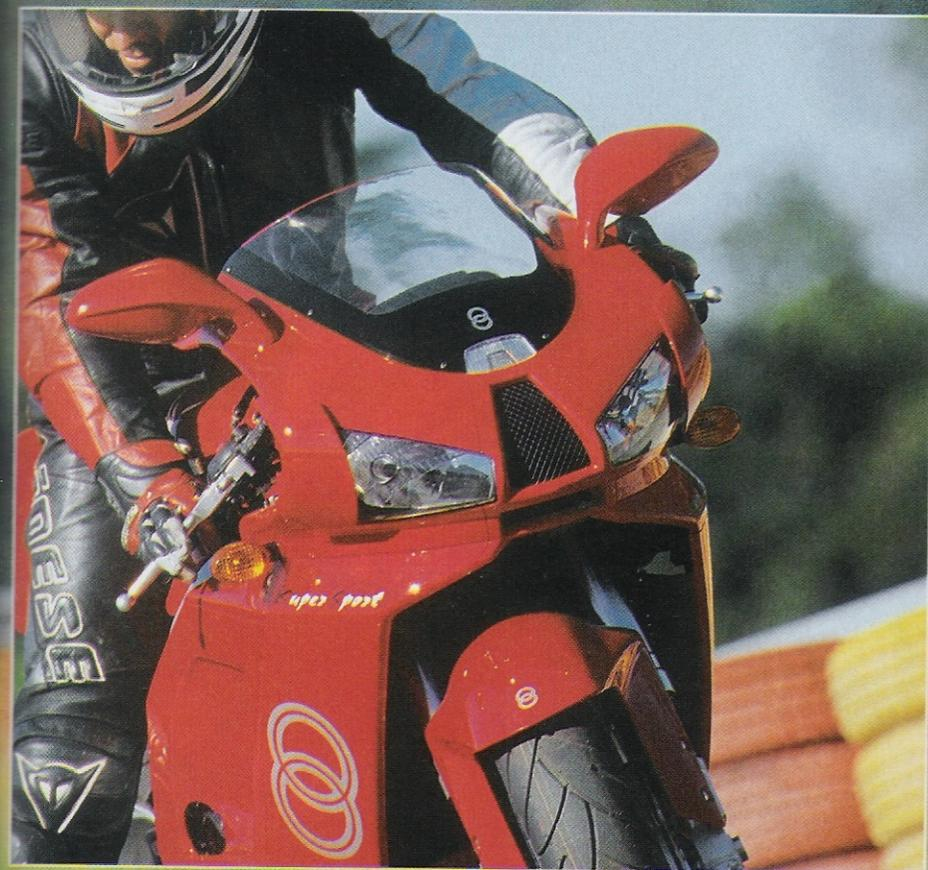
Un cupolino stretto, un frontale che reca al centro una presa d'aria diretta all'airbox, un telaio in lega leggera tanto stretto al centro per non disturbare il pilota. Si presenta subito bene la nuova Gilera che monter  il quattro cilindri Suzuki a iniezione elettronica della serie GSX-R, il motore pi  potente della categoria Supersport 600.
