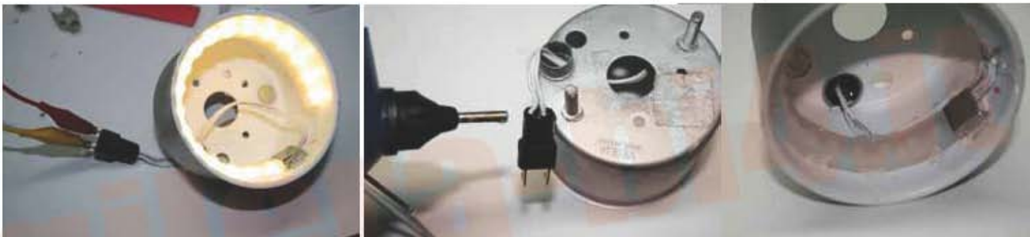
Bloccaggio fili dentro il portalamпада con la pistola a caldo
