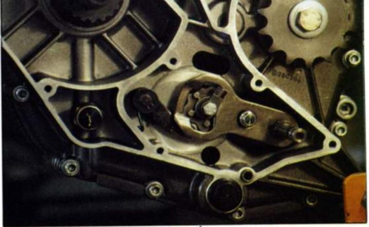
Controllare con il cambio in terza o in quarta velocità che la leva di comando del tamburo selettore possa compiere una eguale corsa nei due sensi (rispetto alla posizione di riposo) prima di entrare in contatto con le spine di trascinamento del tamburo stesso. Eventuali regolazioni si effettuano agendo sull'apposita vite di registro dotata di un controdado.
