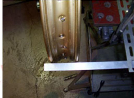
Ho fissato il mozzo in modo stabile in modo che potesse ruotare liberamente ma non traslare, ho usato un perno ruota stretto in una morsa. Poi ho posizionato un semplice riscontro ed ho cominciato a tirare raggi in modo che il cerchio girando rimanesse più o meno alla stessa distanza (pian piano lo avvicinavo).
