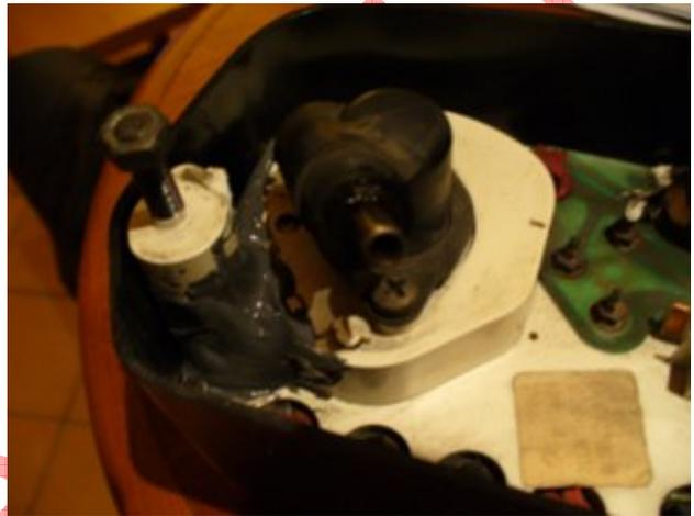
Per quello superiore, si fa quel che si puo': non potendosi "appoggiare" a nessun altro strumento, e' opportuno distribuire un po' di colla intorno all'angolo retto che forma con la strumentazione:
