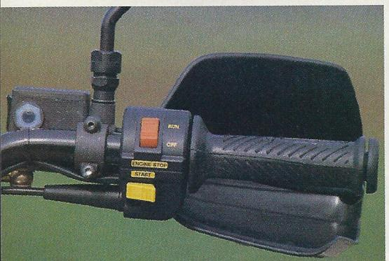
SEMPLICI, MA NON PER QUESTO INEFFICACI SONO I COMANDI AL MANUBRIO: LEVE DI BUONA QUALITÀ E MANOPOLE COMODE SONO AFFIANCATE AD UN COMANDO DELL'ACCELERATORE MOLTO SCORREVOLE. LE FIANCATE ED IL PARACARTER SONO CONFORMATI COME SERBATOI SUPPLEMENTARI E IL PORTAPACCHI POSTERIORE È DI PICCOLE DIMENSIONI. RAFFINATA LA SOLUZIONE SCELTA PER IL FISSAGGIO DELLA SELLA: DUE ATTACCHI A SGANCIAMENTO RAPIDO. SUI FIANCHI SONO TERMOIMPRESSE LE PRESSI DI GONFIAGGIO CONSIGLIATE A SECONDA DELL'IMPIEGO
