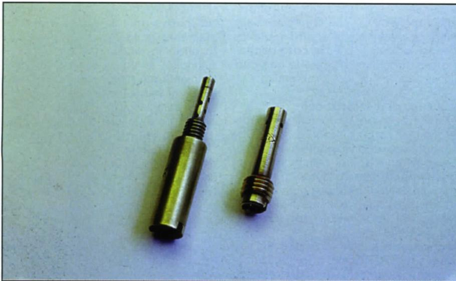
▲ Molto spesso i getti del minimo sono ricavati nello stesso tubetto che fa da emulsionatore, per cui gli elementi di identificazione sono due: il diametro del foro calibrato e le torature di emulsione.
