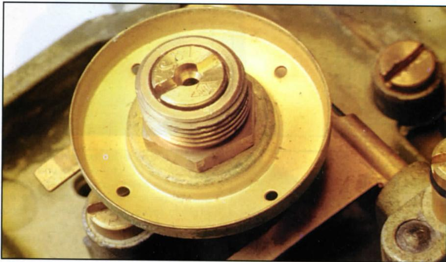
Solitamente i getti del massimo sono definiti dal diametro del foro calibrato, ma non mancano esempi di getti "flussati", che sono identificati dalla portata di carburante che li attraversa in date condizioni di riferimento. In ogni caso non si deve allargare il foro di un getto nella maniera più assoluta!
