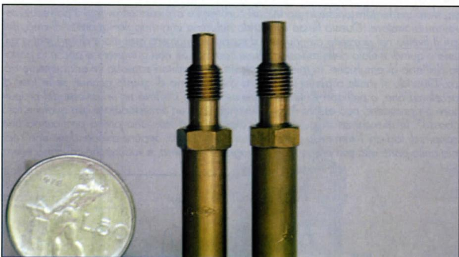
*I pulverizzatori tipo "due tempi" vengono invece realizzati nella versione "alta" ed in quella "bassa", che consente di migliorare l'accelerazione dai bassi regimi, a spese di una maggior ricchezza della carburazione su tutto il campo di aperture.*
