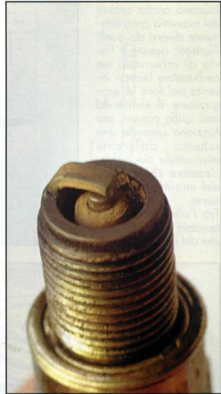
Questa è invece la candela un po' più scura di un 2T, che denota una carburazione un poco ricca; del resto trattandosi di un motore destinato ad un uso stradale la cautela è d'obbligo. Probabilmente il risultato è stato anche falsato dalla eccessiva percorrenza che aveva alle spalle questo elemento; notare le incrostazioni: la candela di prova non deve essere nuova, ma neppure usata come questa!
