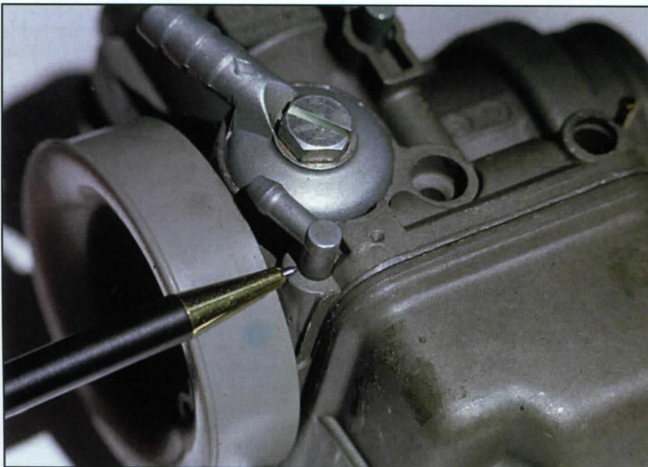
▲ In taluni carburatori (Dell'Orto nella foto) il condotto dell'aria massimo, che alimenta il polverizzatore, è collegato con l'esterno e non direttamente con la presa d'aria: controllare le condizioni di questo condotto e del relativo tubo, perchè se quest'ultimo è otturato o schiacciato la mancanza di aria disturba notevolmente la carburazione.
