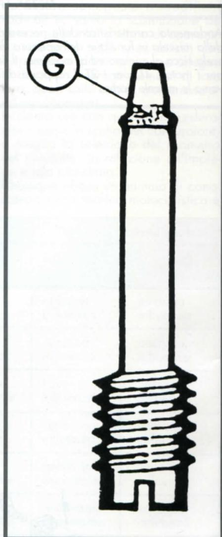
Un altro controllo riguarda gli eventuali elementi di tenuta in gomma (O-R) che si possono trovare sulle estremità delle viti di regolazione aria o miscela. Qualora si riscontri un'usura di questi anelli, sostituirli senza indugio, ed evitare altresì di immergerli a lungo nella benzina o nel solvente utilizzato per la pulizia.
