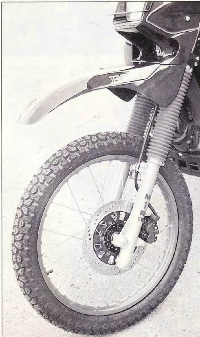
L'avantreno fa sfoggio una forcella Marzocchi M1R con robusti steli da 38; il cilindretto nero montato in fondo allo stelo sinistro è la valvola di regolazione del ritorno idraulico. Il freno a disco in acciaio inox è coniugato ad una pinza flottante con due pistoncini.
