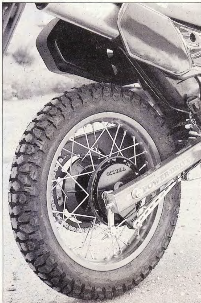
Il forcellone è controllato da un sistema molleggiante a progressività variabile, il Power Drive Gilera, nato e collaudato dalle competizioni e che oggi viene applicato alla produzione di serie con una regolazione della progressione inedita. L'ammortizzatore centrale è a gas e consente un'ampia escursione. Il freno è un tamburo a ceppi flottanti.
