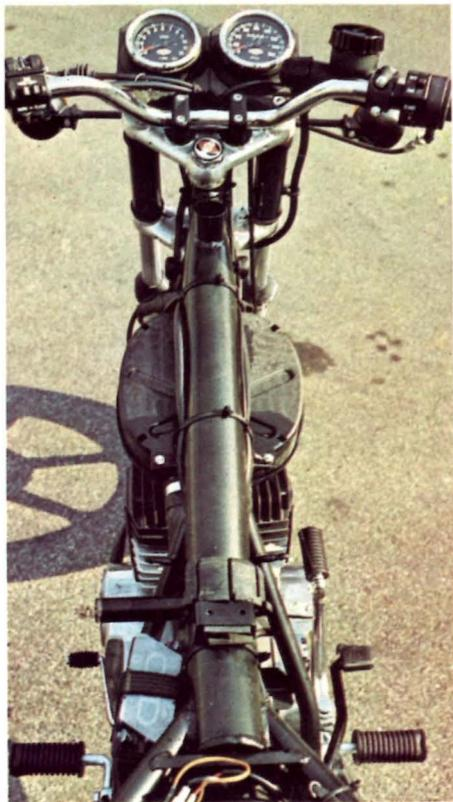
9 La trave superiore del telaio ha la funzione di serbatoio dell'olio. Il filtro è alloggiato sotto.
