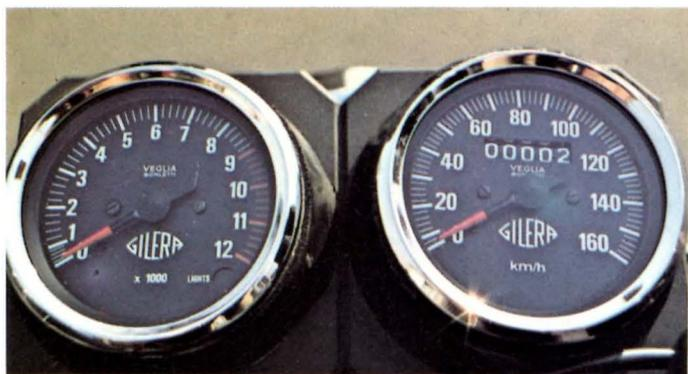
3 La strumentazione è ridotta e imprecisa; la spia delle luci è incorporata nel quadrante del contagiri.
