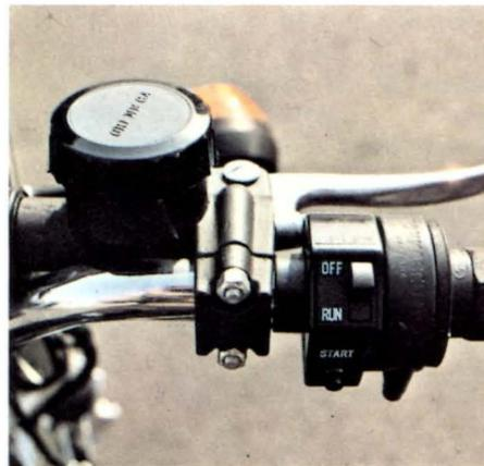
5 Parte destra del manubrio con pompa freno anteriore e interruttore per spegnere il motore.
