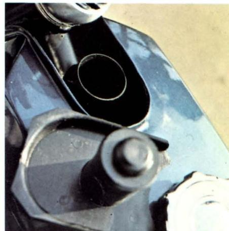
8 Il bocchettone di riempimento del serbatoio dell'olio è subito dietro il cannotto dello sterzo.
