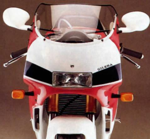
*Ben riuscito il cupolino e ridotta la sezione pontale della carenatura che sottolineano la ricerca finalizzata ad ottenere una alta penetrazione aerodinamica.*
