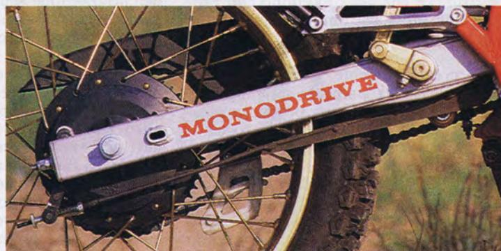
IL MOTORE DELLA ER È PRESSOCHÈ IDENTICO A QUELLO CHE EQUIPAGGIA RRT E FAST BIKE, COME PURE LA CICLISTICA, INCENTRATA SU DI UN TELAIO MONOCULLA SDOPPIATA, CON UN GROSSO TRAVE SUPERIORE. AL RETROTRENO NON MANCA LA SOSPENSIONE MONOAMMORTIZZATORE AD ARTICOLAZIONE PROGRESSIVA, MENTRE IL FRENO È UN TAMBURO MONOCAMMA AD AZIONAMENTO MECCANICO
