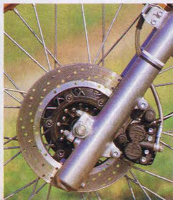
IL TELAIO DELLA RALLY È COMPLETAMENTE DIFFERENTE DA QUELLO DELLE ALTRE ENDURO, ESSENDO STATO STRUTTURATO PER UN IMPIEGO PIÙ ESASPERATO. L'IMPIANTO FRENANTE È DI TIPO MISTO, CIOÈ CON UN DISCO ALL'AVANTRENO ED UN TAMBURO AL RETROTRENO
