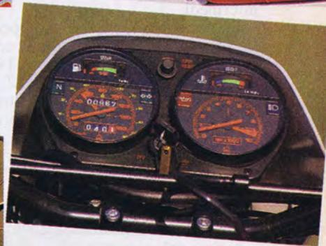
IL CRUSCOTTO È QUELLO GIÀ IMPIEGATO SULLA PRECEDENTE PRODUZIONE ENDURO GILERA, COMPOSTO DA DUE GROSSI STRUMENTI CIRCOLARI DALLA COMPLETA DOTAZIONE. IL DISCO ANTERIORE È DA 240 MM Ø
