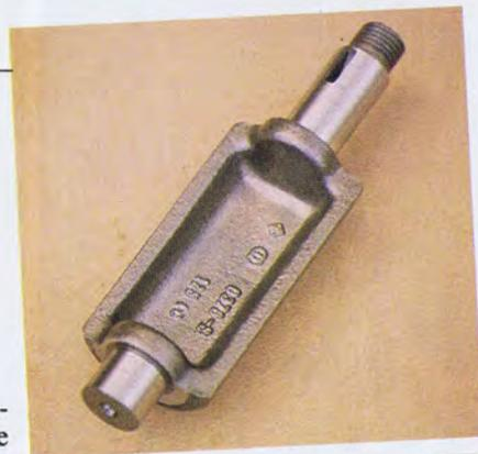
IL BASAMENTO, CHE SI DIVIDE SECONDO UN PIANO VERTICALE, È DOTATO DI UNA GRANDE RIGIDITÀ E APPARE DECISAMENTE COMPATTO. L'EQUILIBRATORE DINAMICO, SOPRA (UN ALBERO DOTATO DI MASSA ECCENTRICA), È ALLOGGIATO SUBITO DIETRO LA FLANGIATURA DI FISSAGGIO DEL CILINDRO
