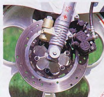
LA FORCELLA DELLA ENDURANCE È DOTATA DI DIFFERENTE SISTEMA DI REGOLAZIONE DELL'IDRAULICA. CARATTERISTICO, E MAGGIORMENTE EVIDENZIATO DALLA COLORAZIONE BIANCA, IL PARAFANGO POSTERIORE SOLIDALE ALLA RUOTA
