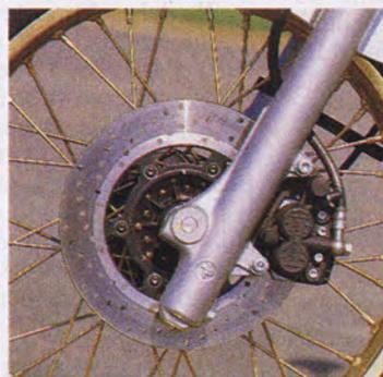
L'IMPIANTO FRENANTE DELLA FAST BIKE VERTE SU DUE DISCHI. QUELLO ANTERIORE, A SINISTRA, È DA 240 MM Ø, MENTRE IL POSTERIORE È DA 230. LA SOSPENSIONE È CON SCHEMA MONODRIVE, CON 140 MM D'ESCURSIONE
