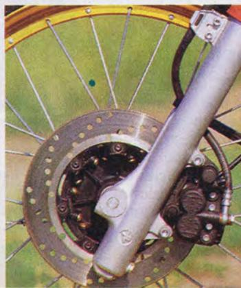
IL TELAIÒ È IDENTICO A QUELLO CHE EQUIPAGGIA ER E FAST BIKE, COME PURE L'IMPIANTO FRENANTE, DI TIPO IBRIDO, A DISCO ALL'AVANTRENO ED A TAMBURO MONOCAMMA AL RETROTRENO
