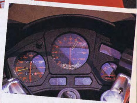
IL PONTE DI COMANDO È DI GRANDE EFFETTO, ARRICCHITO DA UN RIUSCITO CRUSCOTTO A TRITTIKO, CON TACHIMETRO, CONTAGIRI, TERMOMETRO ACQUA ED UNA SERIE DI SEI SPIE LUMINOSE. IL DISCO ANTERIORE È DA 240 MM Ø
