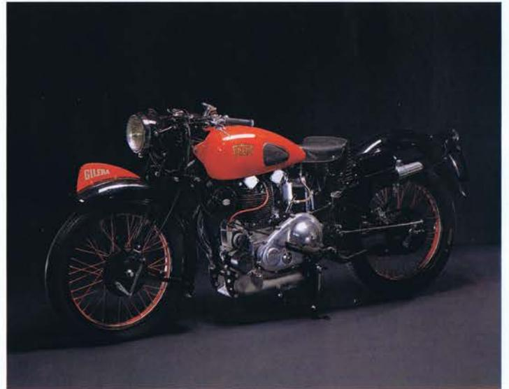
*In alto, la VTGE 500 8 bulloni. È stata la prima moto a valvole in testa costruita in grande serie della Gilera. Sotto, la 350 Super Sport del 1926, con propulsore a valvole laterali in grado di erogare 10 CV a 4.000 giri/minuto.*
