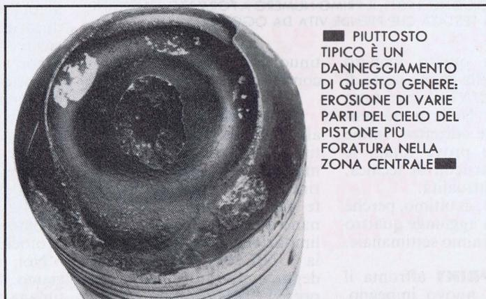
PIUTTOSTO TIPICO È UN DANNEGGIAMENTO DI QUESTO GENERE: EROSIONE DI VARIE PARTI DEL CIELO DEL PISTONE PIU' FORATURA NELLA ZONA CENTRALE
