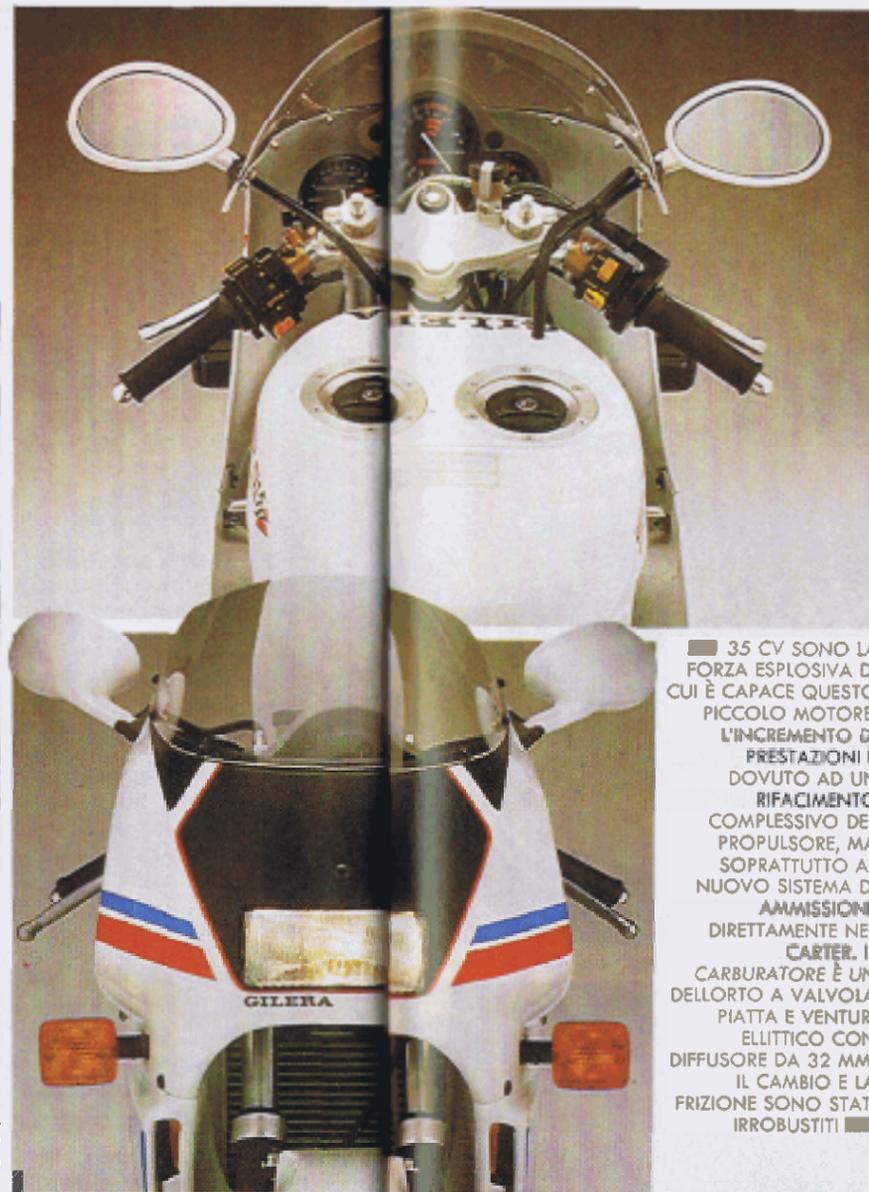
■ 35 CV SONO LA FORZA ESPLOSIVA DI CUI È CAPACE QUESTO PICCOLO MOTORE. L'INCREMENTO DI PRESTAZIONI È DOVUTO AD UN RIFACIMENTO COMPLESSIVO DEL PROPULSORE, MA SOPRATTUTTO AL NUOVO SISTEMA DI AMMISSIONE DIRETTAMENTE NEL CARTER. IL CARBURATORE È UN DELLORTO A VALVOLA PIATTA E VENTURI ELLITTICO CON DIFFUSORE DA 32 MM. IL CAMBIO E LA FRIZIONE SONO STATI IRROBUSTITI ■
