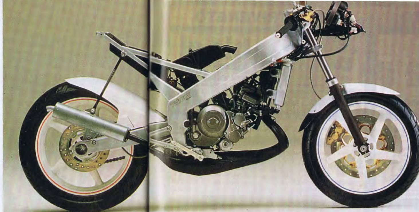
■ A DESTRA, IL DISCO ANTERIORE È FLOTTANTE DA 300 MM Ø, QUELLO POSTERIORE È DA 240 MM Ø. IN BASSO, IL FORCELLONE IN ALLUMINIO ■
