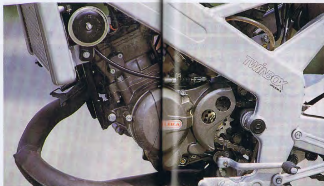
■ SOPRA, IL TELAIO È A DOPPIO TRAVE SUPERIORE PORTANTE IN ACCIAIO SCATOLATO SISTEMA TWIN-BOX. SOTTO, IL MOTORE CON IL RADIATORE IN ALLUMINIO ■
