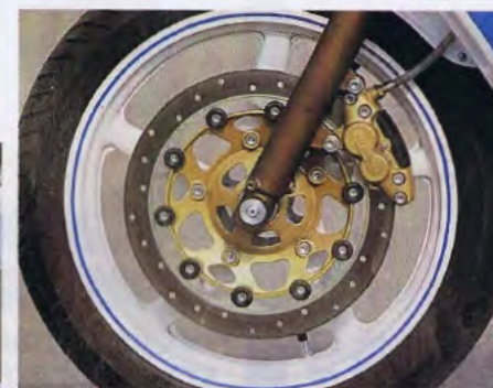
■ A DESTRA, IL DISCO ANTERIORE È FLOTTANTE DA 300 MM Ø, QUELLO POSTERIORE È DA 240 MM Ø. IN BASSO, IL FORCELLONE IN ALLUMINIO ■
