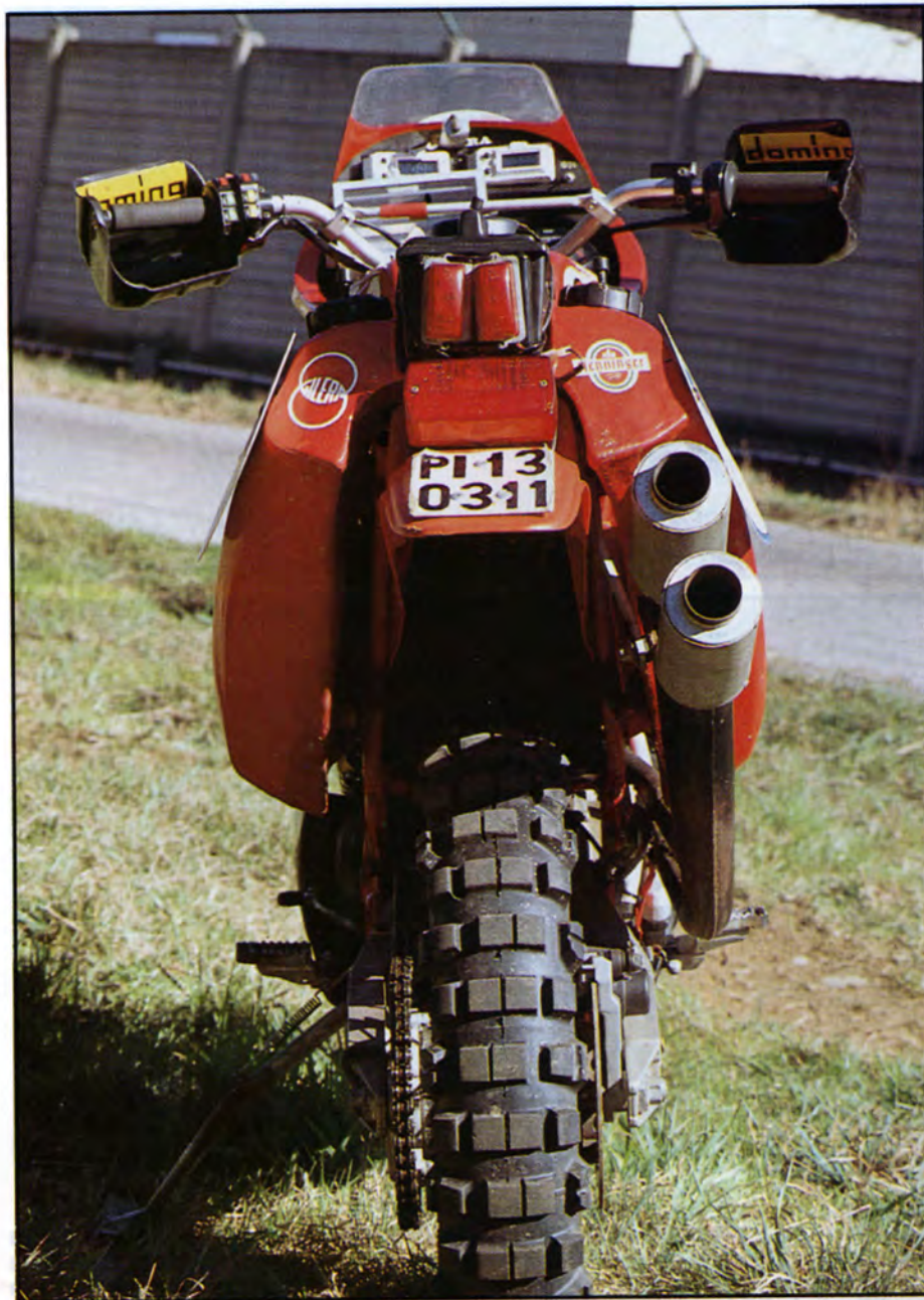
Nella vista posteriore si nota l'ingombro dei due serbatoi ausiliari del carburante - realizzati in lamiera di alluminio - ed il gruppo dei fari montati per obbligo di regolamento.
