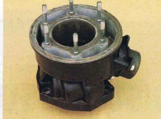
IL CILINDRO HA LA CANNA AL NICHEL-CARBURO DI SILICIO ED È DOTATO DI BEN OTTO CONDOTTI DI TRAVASO. VIENE FISSATO AL BASAMENTO PER MEZZO DI QUATTRO CORTI PRIGIONIERI CON DADO. L'ANDAMENTO DEI TRAVASI È CHIARAMENTE APPREZZABILE ANCHE DALL'ESTERNO
