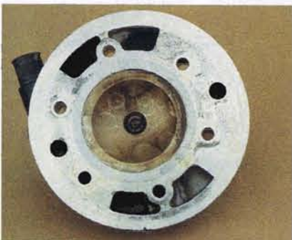
NELLA TESTATA È RICAVATA LA CAMERA DI COMBUSTIONE EMISFERICA CON BANDA ANULARE DI SQUISH DI RIDOTTA ESTENSIONE
