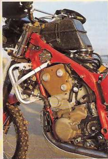
Completamente nuovo il telaio nei confronti della 600: il disegno è a doppia culla con la parte superiore che si allarga per piazzare meglio i due carburatori. Il motore, sotto, non ha nessuna parte in comune con quello di 600 cc anche se mantiene lo stesso angolo delle quattro valvole e la distribuzione con cinghia dentata.
