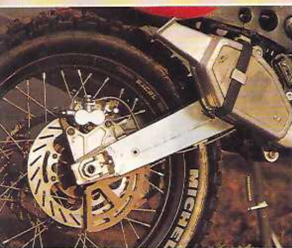
Sopra, il forcellone in lega leggera con sezione differenziata secondo i punti di maggiore sollecitazione. La stampella laterale serve anche da serbatoio per l'acqua del pilota.
