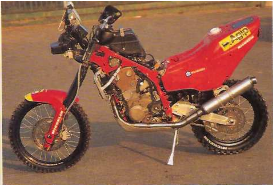
Completamente nuovo il telaio nei confronti della 600: il disegno è a doppia culla con la parte superiore che si allarga per piazzare meglio i due carburatori. Il motore, sotto, non ha nessuna parte in comune con quello di 600 cc anche se mantiene lo stesso angolo delle quattro valvole e la distribuzione con cinghia dentata.
