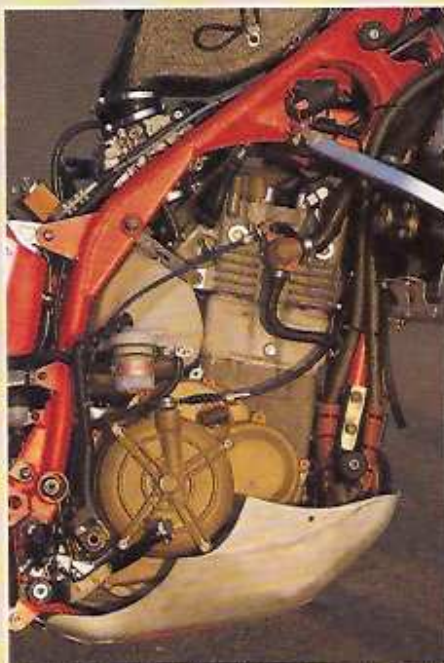
Completamente nuovo il telaio nei confronti della 600: il disegno è a doppia culla con la parte superiore che si allarga per piazzare meglio i due carburatori. Il motore, sotto, non ha nessuna parte in comune con quello di 600 cc anche se mantiene lo stesso angolo delle quattro valvole e la distribuzione con cinghia dentata.
