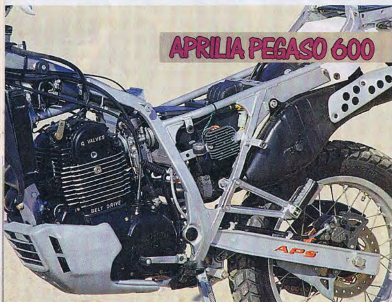
APRILIA PEGASO - IL MOTORE DELLA PEGASO È IL SOLITO ROTAX RAFFREDDATO AD ARIA GIÀ CONOSCIUTO SULLA SERIE TUAREG
