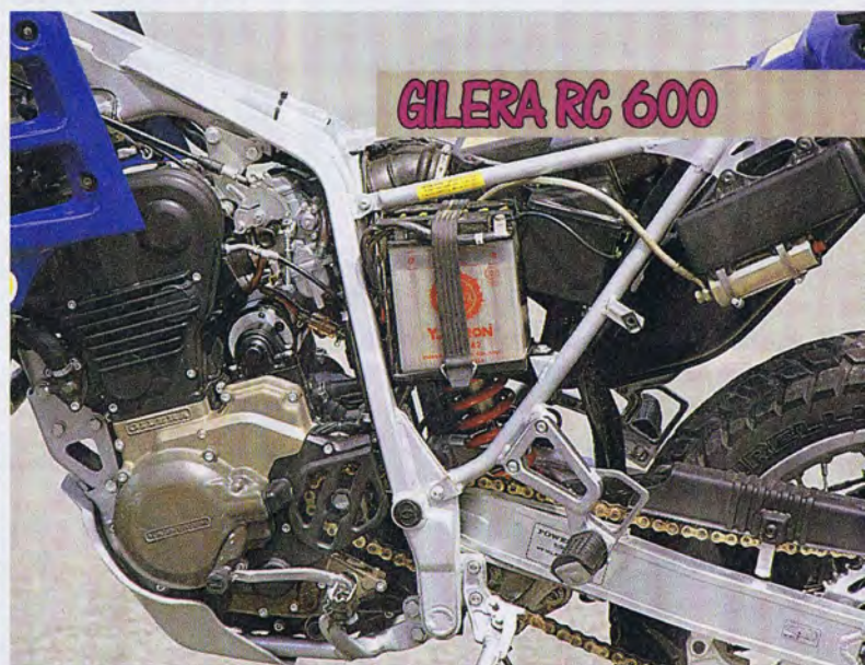
GILERA RC 600 - PUR AVENDO UNA CILINDRATA DI SOLI 570 CM 3 IL MONOCILINDRICO GILERA È FRA I PIÙ PRESTANTI DEL LOTTO
