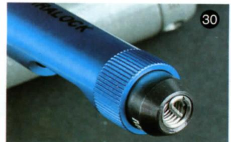
Fig. 29 - A questo punto si introduce l'asta nel corpo e si inserisce la spirale attraverso l'apposita apertura, facendola impegnare nell'asta stessa.
