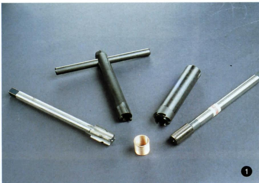
Fig. 1 - Gli utensili del kit Time-Sert della Würth per il ripristino dei fori per candele in ordine di utilizzo: il maschio a doppio diametro; la prolunga con impugnatura e la fresa per le battute della boccola e della candela; il maschio di finitura e ricalcatura.
