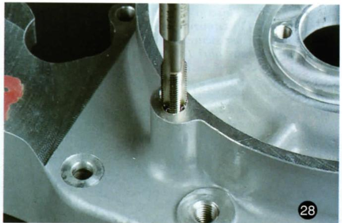
Fig. 28 - Si procede quindi alla maschiatura del foro con l'utensile in dotazione, avendo cura di tenerlo perfettamente "in quadro".
