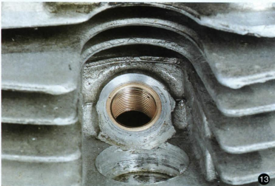
Fig. 10 - Il maschio va accuratamente lubrificato, prima di essere utilizzato per completare l'inserimento della boccia, preventivamente "imboccata" a mano per un paio di giri.
