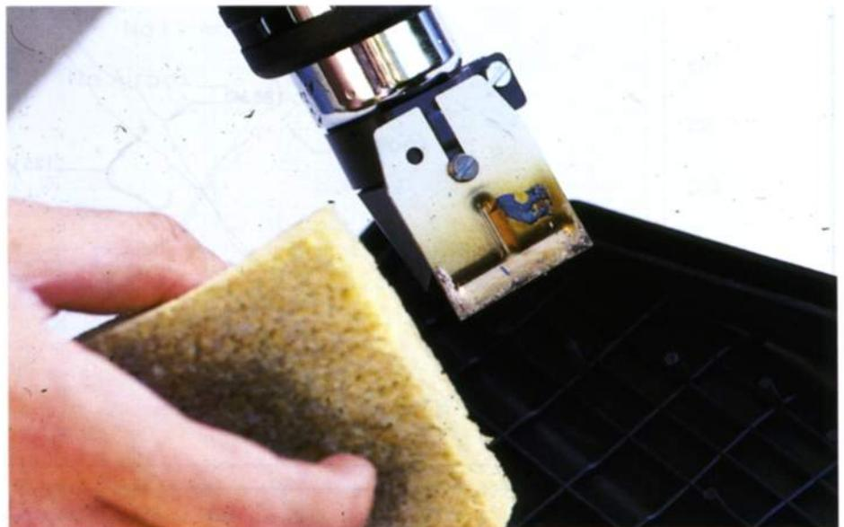
*Quando è necessario (e possibile, valutati gli ingombri) si può modificare il volume interno della scatola filtro scaldandone le pareti con una pistola termica, e modellando la plastica rammollita con una spugna umida. In questo modo non ci si scotta ed inoltre si raffredda rapidamente la zona deformata.*
