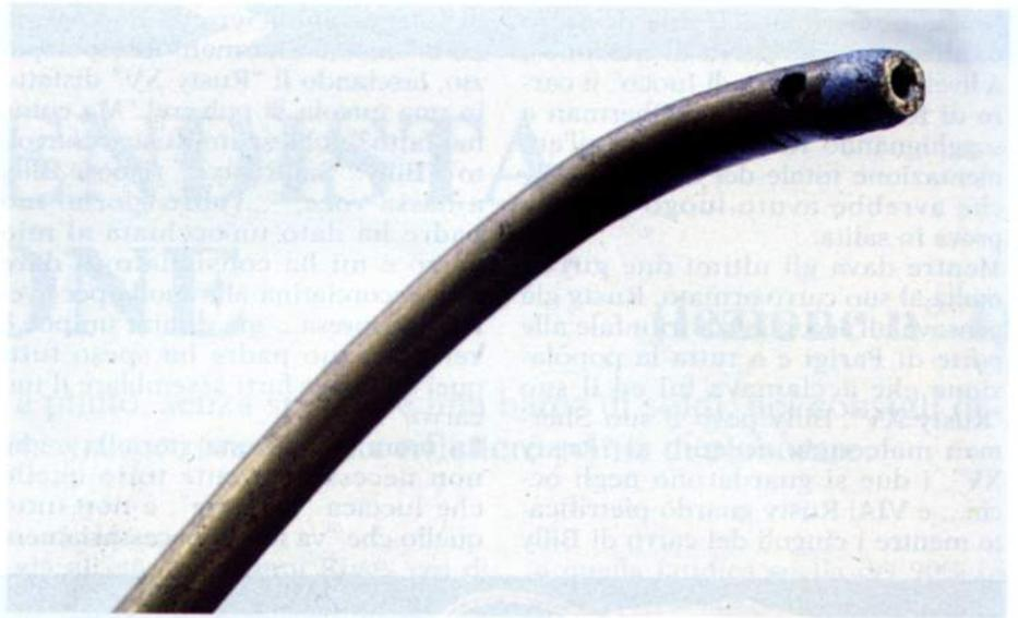
Questa è la "sonda" collegata al tubo del manometro, che il passeggero/aiutante può posizionare nei vari punti di misura (presa d'aria, cassa filtro etc.).
