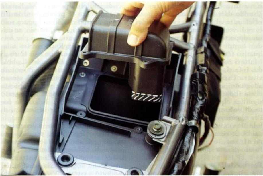
tola. Come citato all'inizio dell'articolo, l'airbox ha la funzione di serbatoio di aria "ferma" da cui il propulsore si approvvigiona d'aria. Il volume della scatola filtro determina la quantità d'aria immediatamente disponibile a monte delle valvole del gas dei carburatori. Per determinare se la scatola filtro è adeguata al propulsore potrete utilizzare i metodi che seguono.
