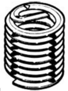
I filetti riportati elicoidali standard sono fabbricati in acciaio inossidabile con precise tolleranze in modo da ottenere un'alta qualità del filetto interno, resistere agli effetti di temperature da  $-160^{\circ}\text{C}$  a  $+420^{\circ}\text{C}$ , alla corrosione, sfregamento e grippaggio e da raggiungere una resistenza alla trazione a bassi costi.
