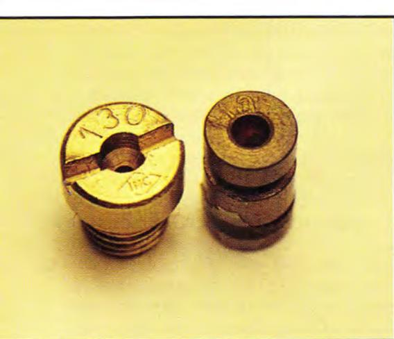
**Fig. 10** – In genere i getti (in particolare del massimo) sono avvitati nella sede; non mancano esempi di getti piantati in un foro e mantenuti in posizione tramite un anellino di gomma.
