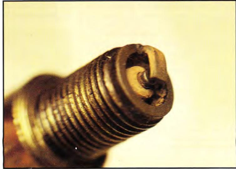
Fig. 14 e 15 – Queste sono due candele che mostrano quale deve essere la colorazione del piede dell'isolante se la carburazione è corretta: una è un poco più chiara, si tratta infatti di una candela di un 4T che è carburato più magro del 2T della prima candela.
