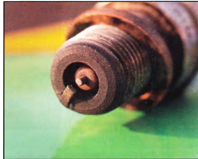
Fig. 15A e 15B – La medesima candela di un motore 2T da competizione vista in due diverse condizioni di carburazione: complessivamente si era rimasti sul ricco – come peraltro richiede quel motore – però si può notare la differenza di colorazione tra la candela più “magra” (a sinistra), e quella “ricca” (a destra, 15B), tale per cui in effetti il pilota sentiva il motore “sporco”. Questa seconda candela ha infatti una evidente tonalità più scura.
