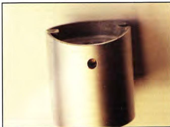
Fig. 2 e 3 – Con lo smusso della valvola del gas si può variare l'entità dell'erogazione per le aperture fino a 1/2 acceleratore; di solito la misura stampigliata indica la quota S in mm o in decimi di mm. Il tappo piantato nella valvola della foto blocca una piccola molla, che impedisce allo spillo di muoversi nel suo alloggiamento e di urtare nel polverizzatore, danneggiando l'accoppiamento.
