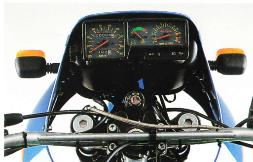
Particolare cruscotto con tachimetro, contachilometri parz.-tot, temp. H 2 O, contagiri e spie indicazioni
