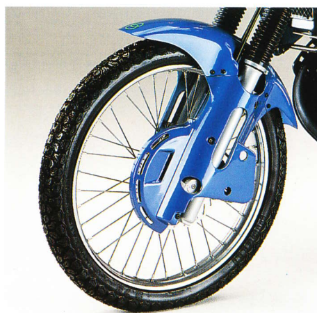
Particolare ruota anteriore con copridisco avvolgente
