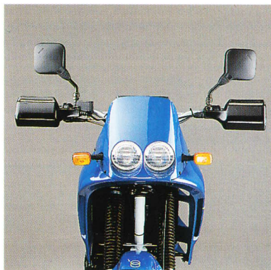
Vista anteriore cupolino, bifaro, paramani
