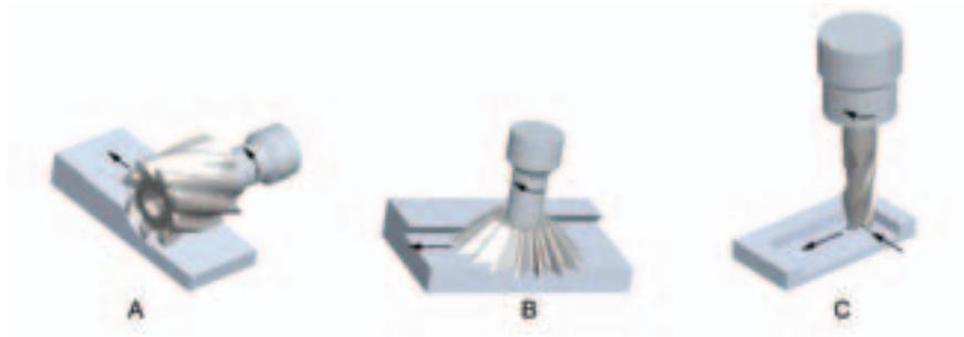
Nella fresatura periferica l'asse di rotazione della fresa è parallelo alla superficie in lavoro. La fresa è munita di una serie di denti disposti lungo la circonferenza, ogni dente agisce come un utensile da taglio a punta singola, definito fresa semplice. Le frese impiegate nella fresatura periferica possono essere dotate di denti dritti o elicoidali.
