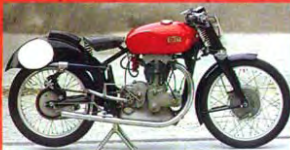
La Saturno Sanremo, così chiamata dopo la vittoria di Bandiera al circuito di Ospedaletti nel 1947, è caratterizzata da una forcella a parallelogramma con struttura scatolata in lamiera e dal freno anteriore centrale.
