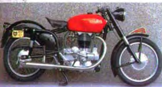
La Saturno Sanremo, così chiamata dopo la vittoria di Bandiera al circuito di Ospedaletti nel 1947, è caratterizzata da una forcella a parallelogramma con struttura scatolata in lamiera e dal freno anteriore centrale.
