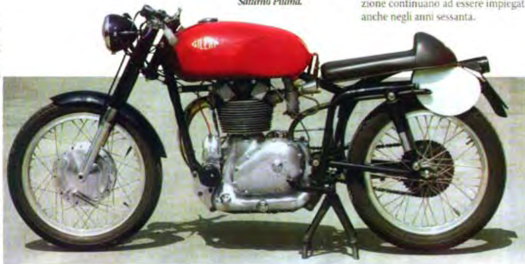
Nel 1952, sia la Saturno Sport, foto a lato, sia la Competizione, foto in basso, adottano una telescopica ed un forcellone oscillante con doppi gruppi molla-ammortizzatore idraulico. Quelli del modello Competizione sono uguali a quelli delle quattro cilindri. Per la sua leggerezza questo modello verrà chiamato Saturno Piuma.
