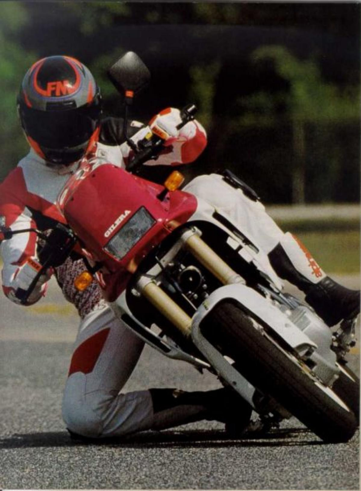
A livello dinamico, la moto di Arcore non manca di stupire: l'impiego di cerchi da 17" a tre razze con pregevoli pneumatici radiali superribassati (120/70 l'anteriore e ben 160/60 il posteriore) inseriti in un telaio con geometria prettamente da enduro, portano ad uno stravolgimento delle quote ciclistiche tipiche della categoria. Il risultato finale è un interesse più corto e un baricentro più basso; a garanzia di una maneggevolezza e di una stabilità ben superiori alle dirette avversarie.
