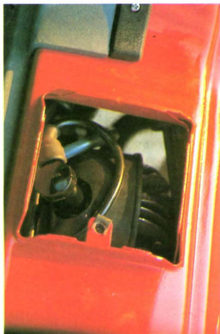
17 L'accesso rapido alla candela e alla testa è assicurato da un portello a vite. Notare la cuffia che convoglia l'aria di raffreddamento alla testa.
