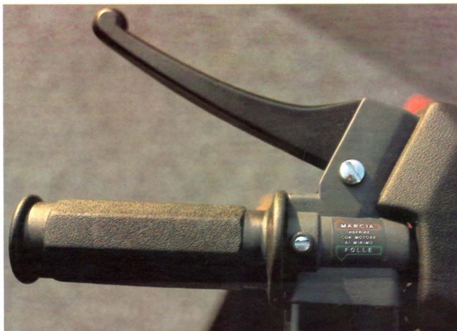
8 Per l'avviamento, si ruota all'indietro la manopola sinistra, per porre la trasmissione in folle, poi, con il motore al minimo, si ruota la manopola in avanti e si dà gas.
