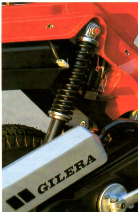
14 Tradizionale Piaggio, la sospensione monoammortizzatore asimmetrica per la ruota posteriore.
