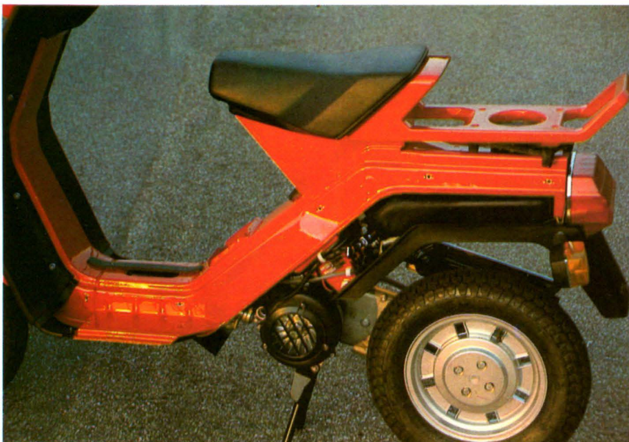
22 La robustissima scocca-trave in lamiera stampata dà un'idea del motivo per cui il GSA fornisce una sensazione immediata di solidità e stabilità.
