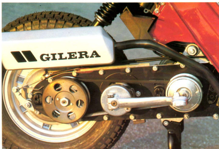
15 Come nella tradizione Piaggio, il braccio della sospensione rappresenta il supporto per tutto il gruppo propulsore, motore e trasmissione. Qui si evidenziano gli elementi della trasmissione a variatore e l'avviamento kick.
