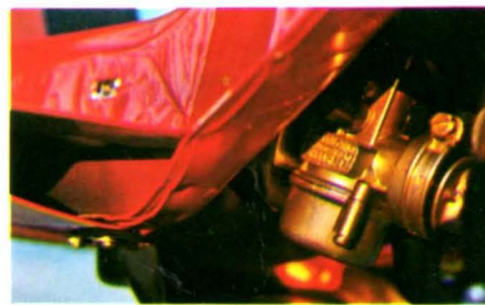
19 Il carburatore è in posizione ben protetta da un deflettore. L'accessibilità è discreta.
