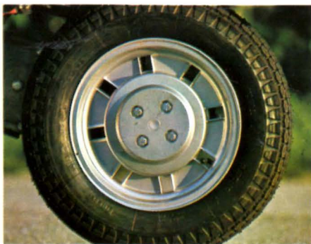
11 La ruota posteriore è a sbalzo, fissata da quattro bulloni, e facilmente accessibile. Notevole, per un 50, la misura dei pneumatici.
