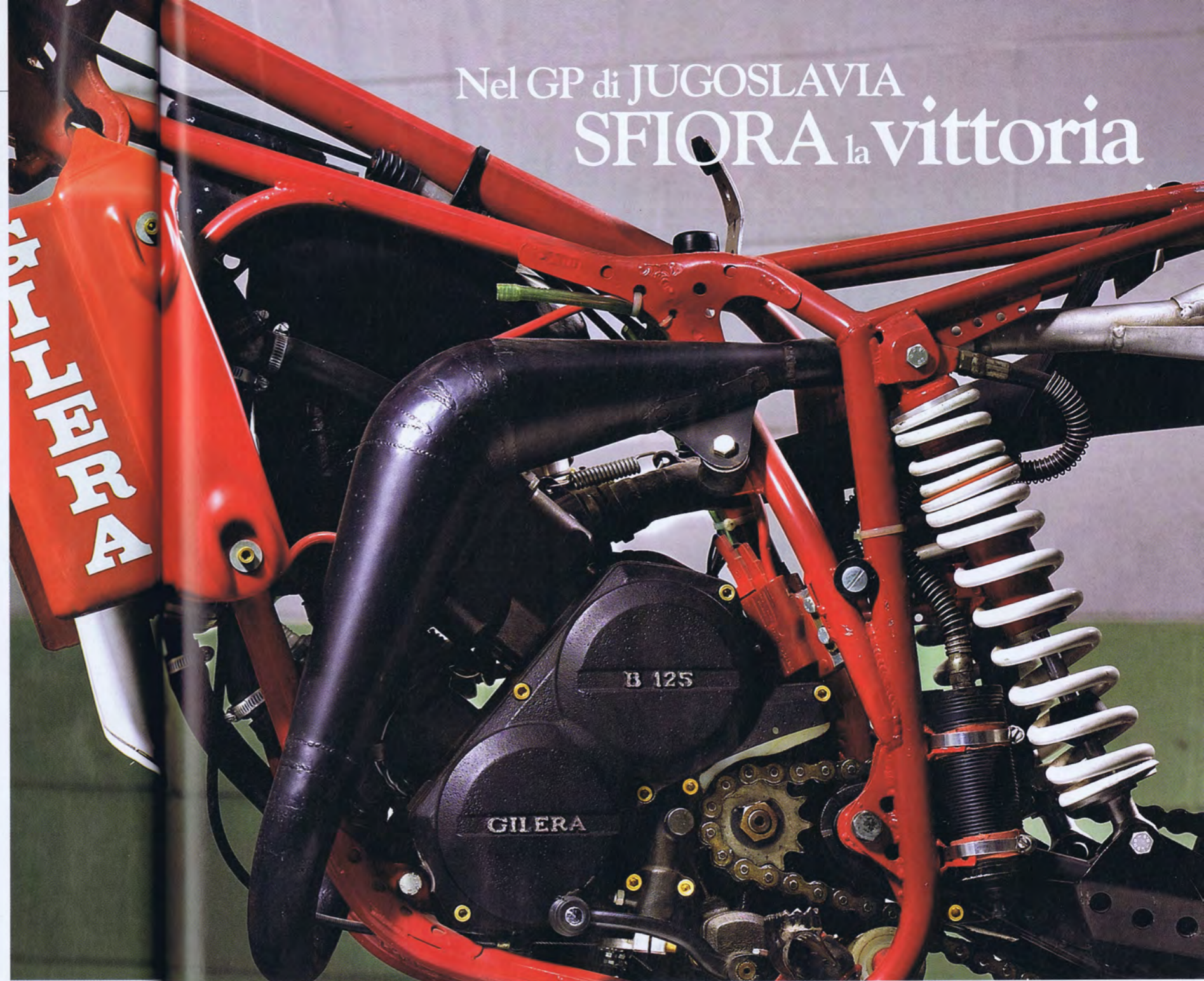
ALESAGGIO E CORSA DA 44X41 MILLIMETRI. Ecco le misure vitali del bicilindrico di Arcore. Il sei marce progettato dall'ingegner Witteveen aveva carter esterni in magnesio. Per la coppia di carter centrali vennero realizzate due versioni. Una in alluminio che garantiva maggior stabilità alle elevate temperature, ed una in magnesio che invece consentiva un risparmio di peso di circa due chilogrammi. I carter erano fusi dalla Flam.
