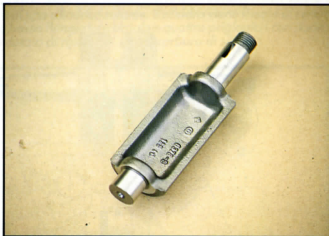
▲ L'albero ausiliario di equilibratura è dotato di una massa eccentrica centrale assai allungata, ruota su due cuscinetti a sfere e viene azionato da ingranaggi posti sul lato destro (quello cioè della trasmissione primaria).
