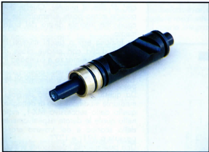
▲ La valvola parzializzatrice è di tipo rotante e funge anche da otturatore del condotto di collegamento al risonatore di scarico. È in lega di alluminio trattata ed agisce sia sul condotto principale che sui due boosters.
