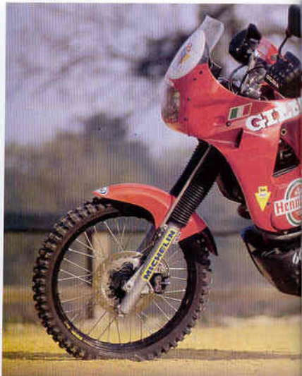
Principale modification de la Gilera, l'autonomie passe de 13 à 56 litres grâce aux trois réservoirs en aluminium.
