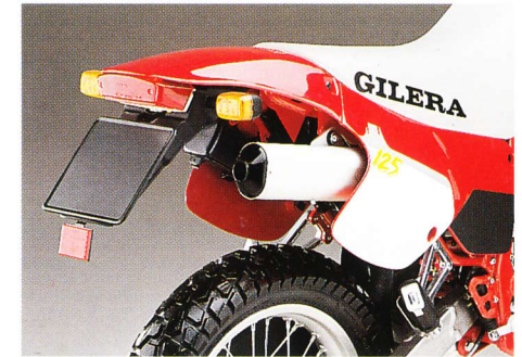
Vista posteriore veicolo con faretto di nuovo disegno e silenziatore di scarico in alluminio
